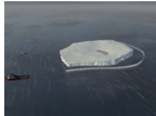
Om het verslepen van ijsbergen tot een succes te maken, is het cruciaal dat het smeltproces tijdens transport wordt vertraagd. Daarom hebben Georges Mougin en zijn projectpartner François Mauviel een isolerende jas ontworpen die in zijn geheel om de ijsberg komt te zitten. Deze rok is opgebouwd uit vele verticale strips, die aan een op het water drijvende gordel hangen. De rok steekt 6 m boven het water uit om golven af te schermen, maar gaat ook tot 6 m diep, omdat de bovenste laag zeewater het warmst is. Eerst brengen sleepboten die de gordel om de ijsberg heen. In de gordel zitten de strips opgerold, de zwaartekracht moet er vervolgens voor zorgen dat de strips zich geheel ontvouwen.
